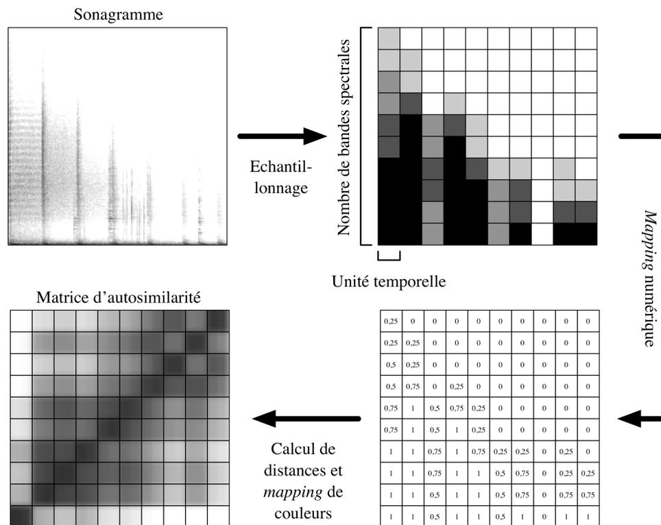
FIGURE 2.17 – Le principe du calcul de la matrice de similarité à partir de l’image du tracé spectral.
