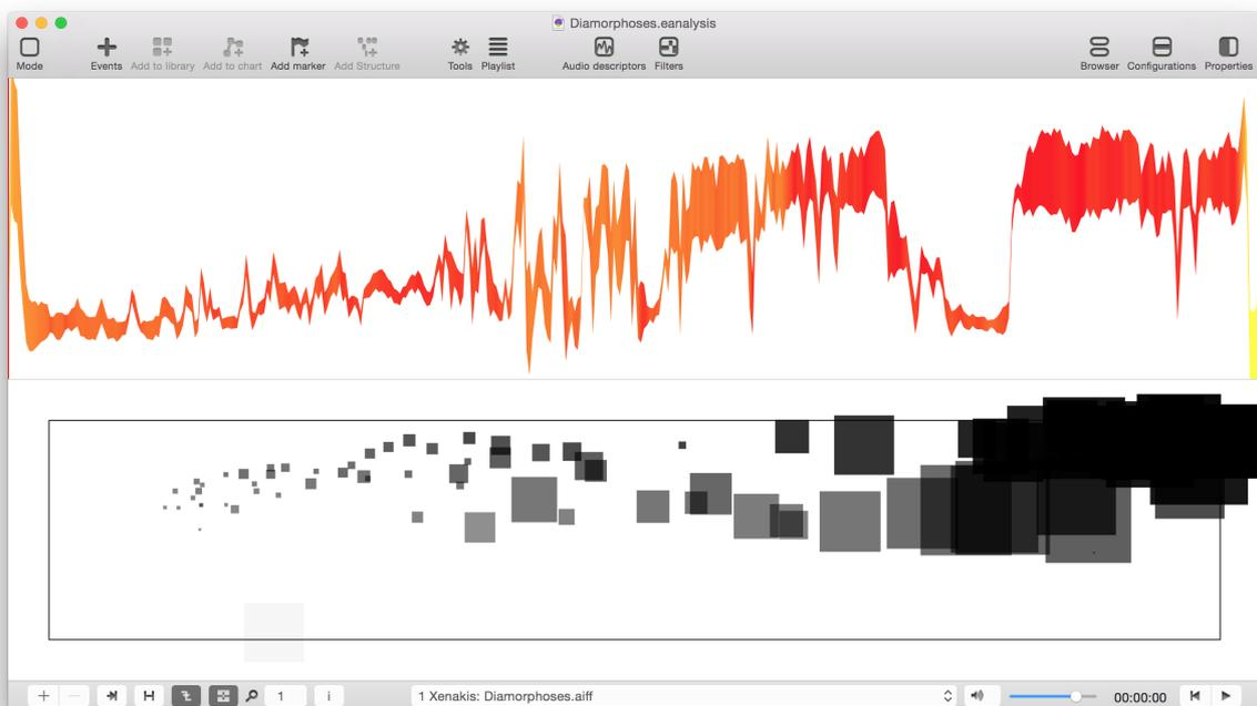
FIGURE D.2 – Exemple de représentations complexes (de haut en bas) : *Brightness Standard Deviation* (X : *spectral rolloff*, épaisseur de la ligne : variance spectrale, couleur : *loudness*) et graphique en nuage de points (X : *spectral rolloff*, Y : *loudness*, taille : inharmonicité, opacité : *spectral sharpness*).
