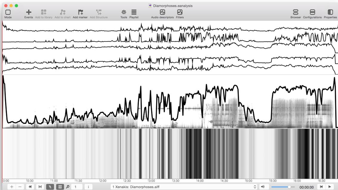
FIGURE D.1 – Exemple de représentations simples (de haut en bas) : cinq descripteurs (variance spectrale, inharmonicité, *spectral sharpness*, *spectral rolloff*, *loudness*), *spectral rolloff* sur sonagramme, inharmonicité en dégradés.
