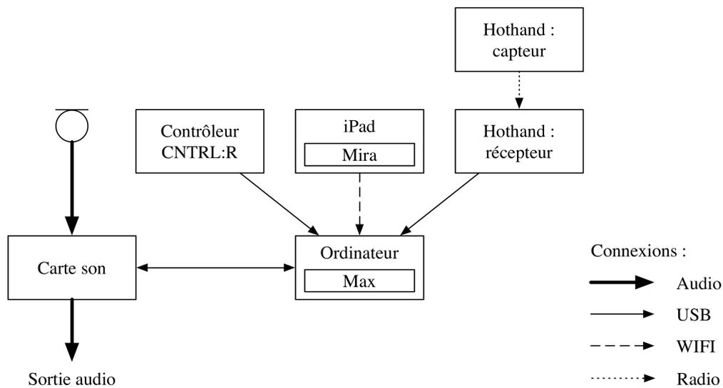
FIGURE 3.2 – Notre dispositif de jeu pour l'improvisation électroacoustique.
